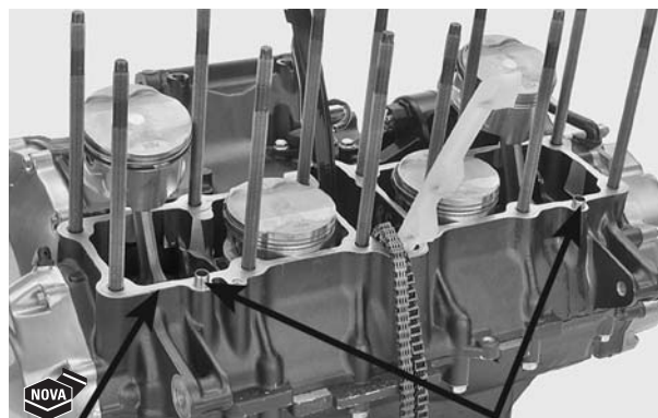
JUNTA COMPRESSOR DE ANÉIS DO PISTÃO PINOS-GUIAS
